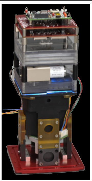
MisST Imager: 2U Nanosat payload
